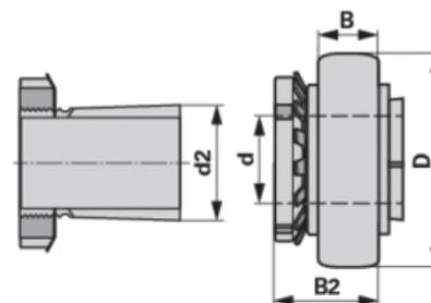
FAG-Spannlager mit sphärischen Außenring basierend auf einreihigen Rillenkugellager 62.. und sind ausgelegt nach JIS B 1558.
