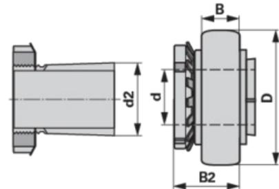
FAG-Spannlager mit sphärischen Außenring basierend auf einreihigen Rillenkugellager 62.. und sind ausgelegt nach JIS B 1558. Die Innen- und Außenringe sowie die Schleuderscheiben haben aufgrund der schwarzen "Durotect" - Beschichtung einen Basiskorrosionsschutz. Die Black-Series-Spannlager gibt es mit zwei Befestigungsarten und einer Dichtungsart.
